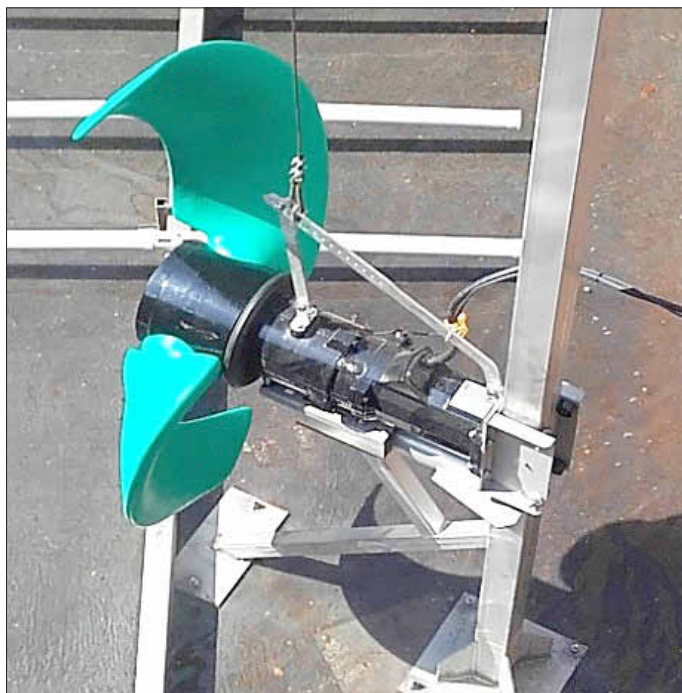
Das neue Rührwerk.
